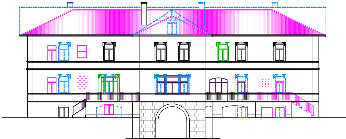
SJEVERNO PROČELJE - faze gradnje pojedinih dijelova
