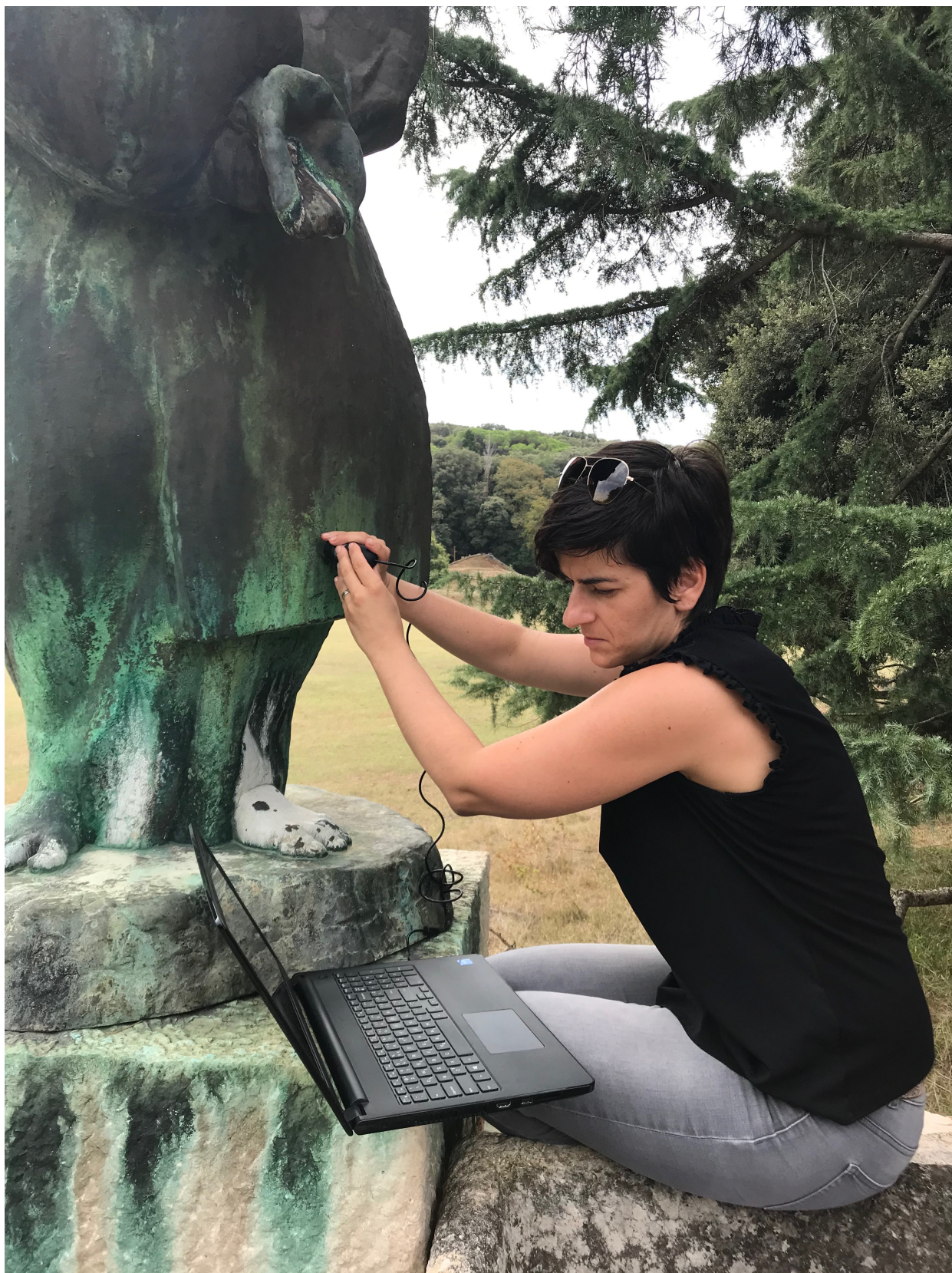
Sl.33. Snimanje površine skulpture elektronskim mikroskopom
